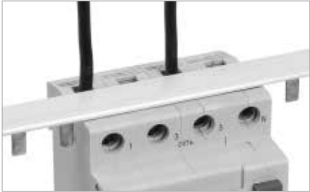
Реализована возможность двойного одновременного присоединения как шиной (PIN или FORK) так и гибким проводником сечением до 25 мм².
