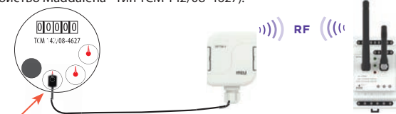
Размещение датчика на магнитном счетчике воды
