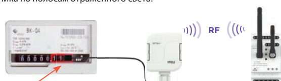
Размещение датчика на газовом счетчике
