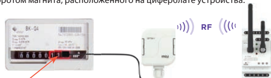
Встроенный магнит в газовом счетчике
